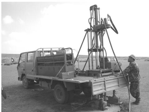
图2 CQK-50型车载化钻机全貌
