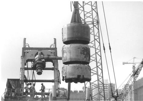
图 1 滚刀钻头及钻具连接示意图
