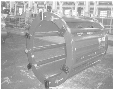
图4 HC-15型大直径环状取心潜孔锤实物图
