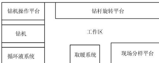
图2 冰上湖泊钻探平台平面示意图
