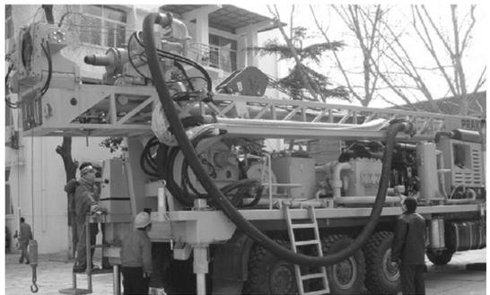
图2 德国BAUER公司生产的RB50车装水井钻机
