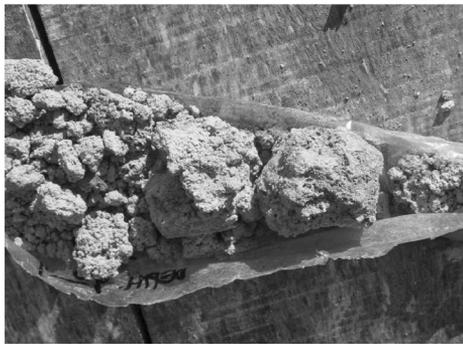
图2 松散、裂隙、空洞尤其蜂窝结构发育的风化石灰岩
