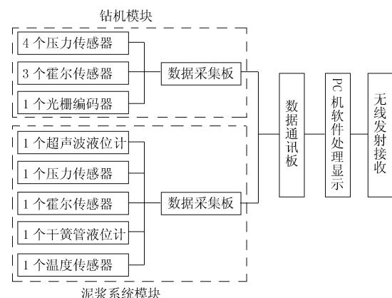
图 1 系统结构图
