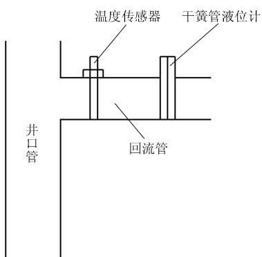
图 7 干簧管液位计安装示意图
