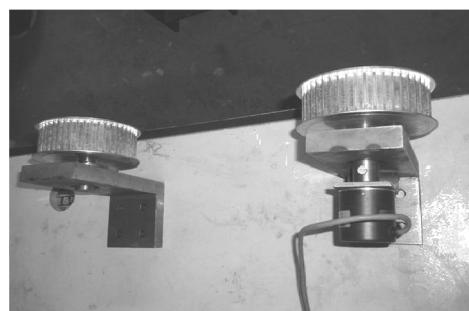
图 2 同步带轮及光栅编码器实物图
