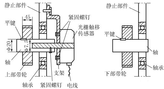
图 3 同步带轮及光栅编码器设计图
