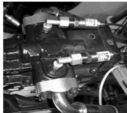
图5 液压马达压力传感器安装图
