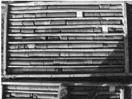
图2 SA75<sup>+</sup> 绳索取心钻具采取的岩心
