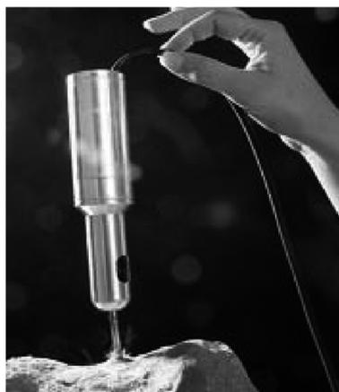
图 1 最小轴向力下的 USDC 取心图
