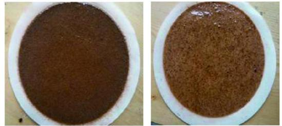
图2 主剂植物胶加辅剂聚丙烯酰胺前后对比滤饼图
