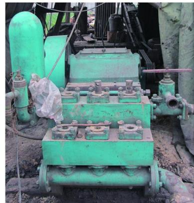
图5 NBB-390~52/11~8型变量泥浆泵施工现场
