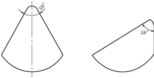
图3 尖齿II型PDC形状
