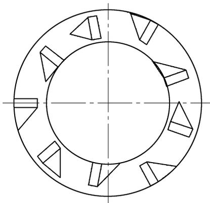
图4 尖齿PDC平面布置结构
