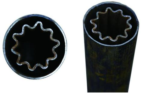
图 13 波纹管膨胀效果图
