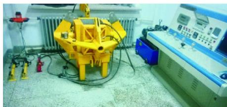
图 7 水力压裂实验台
