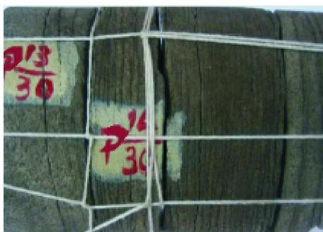
图5 岩心照片(地层岩心裂缝)
