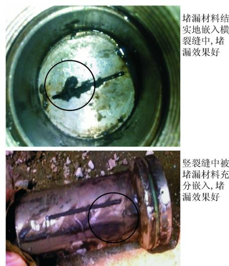
图 3 横裂缝和竖裂缝的堵漏效果图
