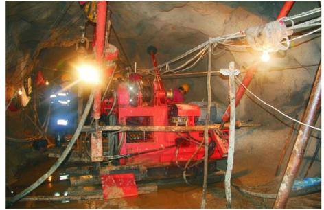
图5 KDZ-300型坑道钻机在云南某坑道内施工
