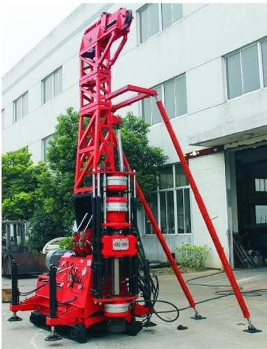
图4 小型塔机一体式钻塔及钻机
