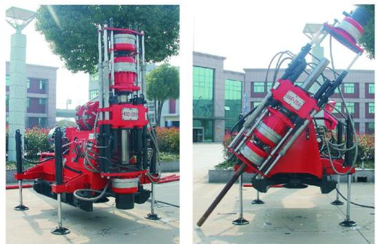
图1 KDZ-300型坑道钻机
