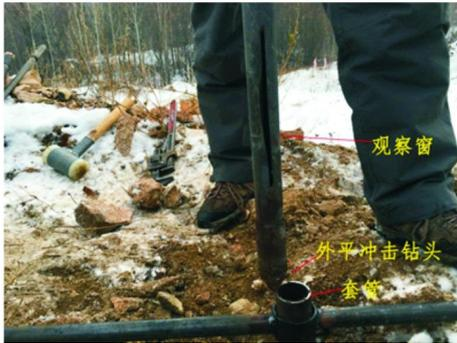
图10 钻具及套管
