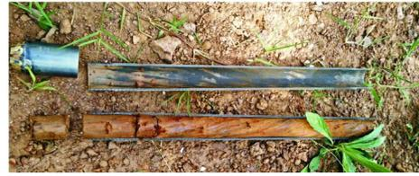
图14 半合管采取的土壤样品
