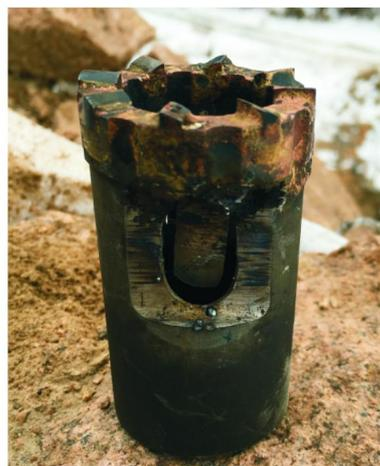
图3  $\varnothing 40/26$  mm的尖齿硬质合金钻头
