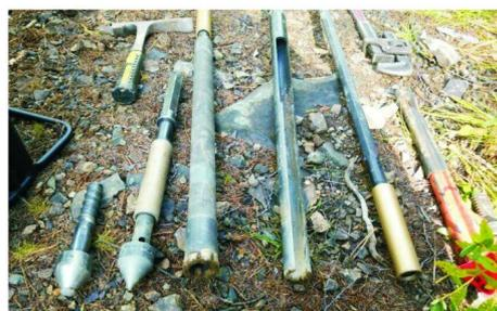
图2 锥形钻头、取心钻头及单管钻具
