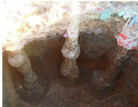
图 3 放电后所成葫芦状桩型
