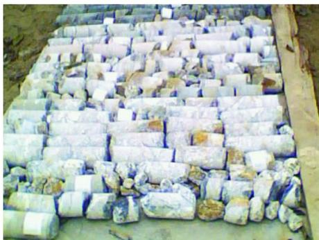
图 2 孔深 69.00 ~ 92.40 m 钻遇破碎地层
