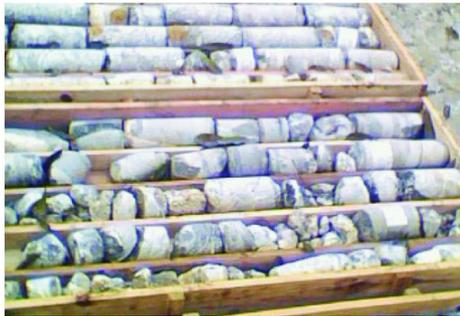
图 1 孔深 50.00 ~ 68.38 m 钻遇破碎地层
