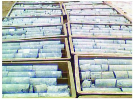
图 4 后期钻遇较完整地层
