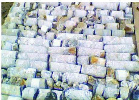
图 3 孔深 326.76 ~ 499.44 m 钻遇破碎地层
