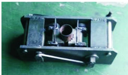
图7 新型夹持器样机(夹持钻杆接头状态)
