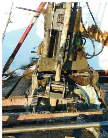
图8 新型夹持器野外试验现场
