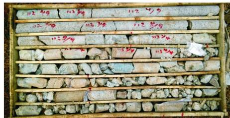
图2 下部破碎坍塌掉块层岩心
