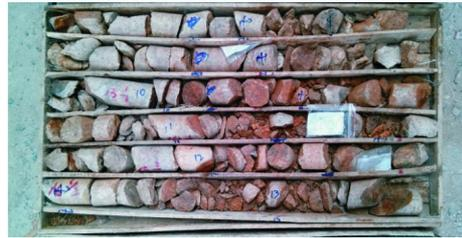
图1 上部破碎漏失层岩心
