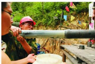
该钻具是将  $\varnothing 114$  mm 普通绳索取心钻杆连接  $\varnothing 150$  mm 加重管及钻具和  $\varnothing 152$  mm 特殊钻头的组合方式,同时将绳索取心内管总成设计为密闭取心结构,解决了大直
