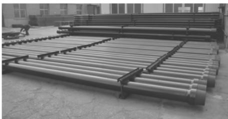
图 2 SG219/152 双壁钻杆实物图
