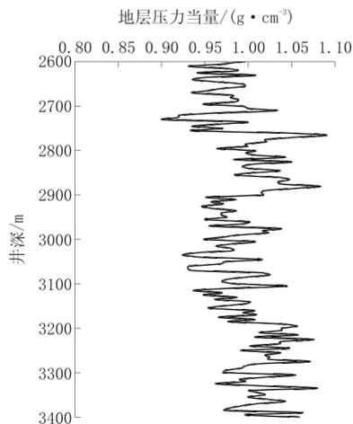
图2 钻后声波时差法计算地层压力(12 $\frac{1}{4}$  in井段)
