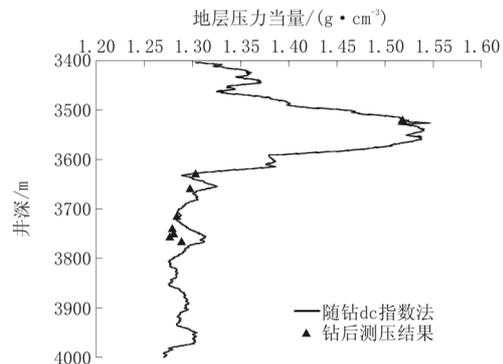
图3 随钻dc指数法计算地层压力与钻后测压对比(8 $\frac{1}{2}$  in井段)
