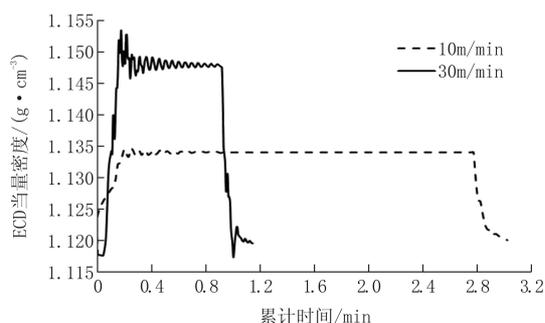
图 6 下钻“激动”压力分析
