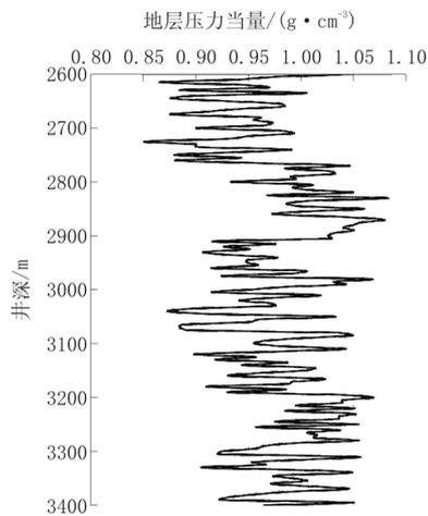
图1 随钻dc指数法计算地层压力(12 $\frac{1}{4}$  in井段)
