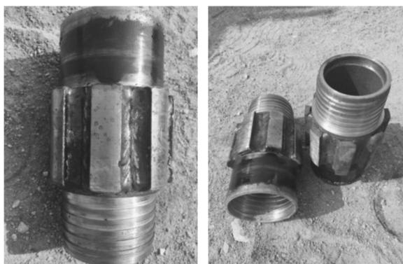
图 4 Ø108 mm 钻具扶正器实物
