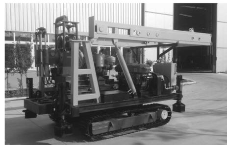
图 1 GJ-240L 型履带式工勘钻机整体结构
