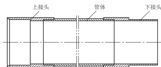
图 1 专用套管结构示意图
