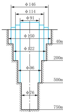
图 2 ZK12-1 孔钻孔结构
