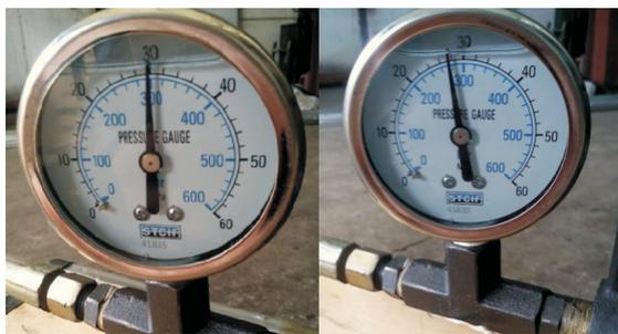
图 7 保压筒保压 2 h 前后压力变化
