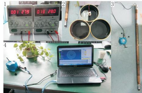
1—电源;2—测量电极;3—数据处理及发送;4—数据接收及显示
