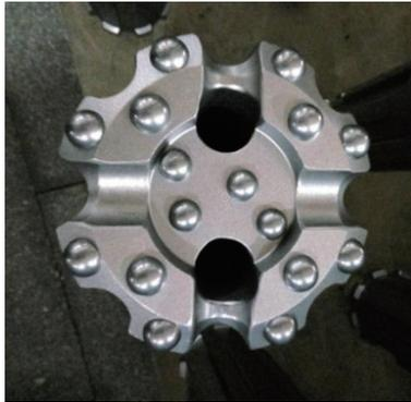
图4 改进流体构造的钻头
