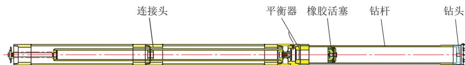
图8 活塞式钻具结构
