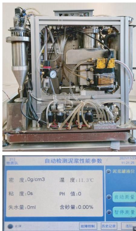
图12 钻探泥浆性能多参数自动测量装置
