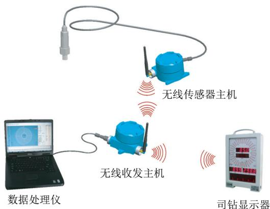
图11 地质岩心钻探多参数孔底自动监测装置地面系统
