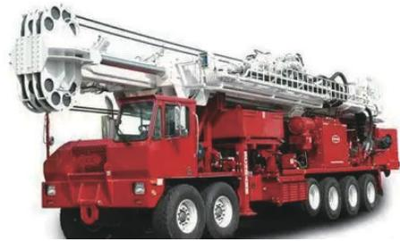
图2 美国雪姆 T200 型车载钻机
