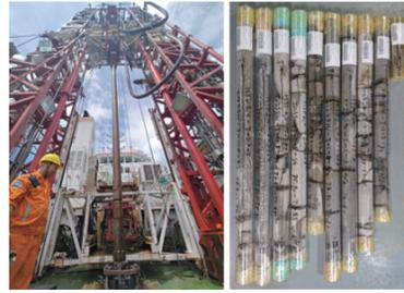
技术,研制出 $\varnothing 197$  mm规格的中空螺杆马达取心器具,回次取心长度7.3 m,取心直径55 mm。本次海试采用自主研发的中空螺杆作为井底动力取心钻具,搭载广州
