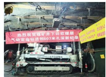
气动定向钻进技术与装备逐渐走向成熟完善。目前气动定向钻进技术已成为煤矿井下瓦斯治理的重要技术手段,在安徽、贵州、山西、河南、河北等地区广泛推广应用,对革新碎软煤层瓦斯治理模式,提升碎软煤层矿井瓦斯抽采治理水平具有重要意义。
