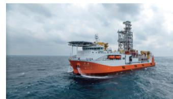
按16级台风海况安全要求设计,具备全球海域无限航区作业能力和海域11000 m的钻探能力。具有全球最先进的钻探系统,其中深水无隔水管泥浆循环系统(RMR)由我国自主研
