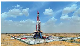
深地塔科1井地处塔里木盆地中心的塔克拉玛干沙漠腹地,是中国石油在塔里木油田实施的重大“深地工程”,设计井深11100 m,钻井完井周期457天。部署钻探深地塔科1井的目的是开展万米级特深层地质、工程科学探索研究,以技术突破挑战深地钻井极限,深入探索地球内部结构和演化规律,进一步为地球科学研究提供重要的数据支持。深地塔科1井采用我国自主研发的全球首台12000 m特深井自动化钻机,载重提升能力达到最大9000 kN。
