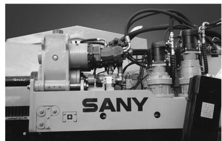
图 2 SD7535 型钻机动力头
