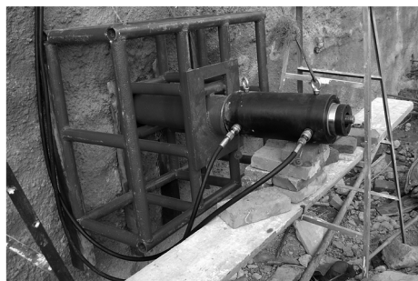
图2 土钉抗拔力测试方法
