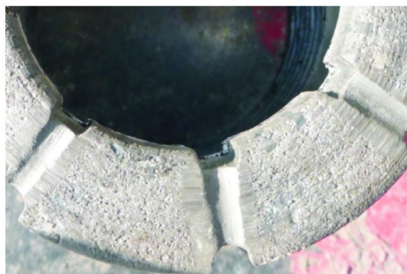
图3 平底唇面金刚石钻头
