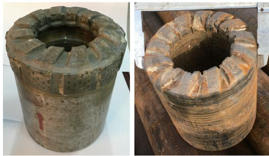
(a) 超高胎体偏心齿钻头 (b) 钢体偏心齿钻头
