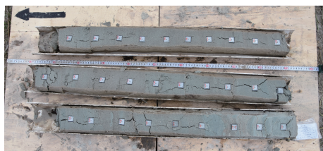
图6 单回次粗砂层取心效果
