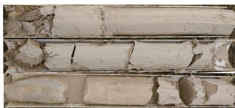
图5 单回次细砂层取心效果
