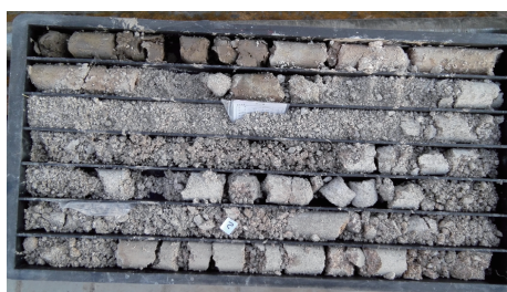
图8 单回次风化基岩取心效果
