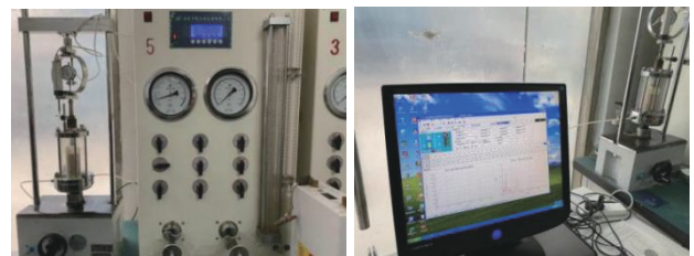
图9 全风化泥质灰岩三轴剪切试验
