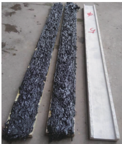
图4 沥青料在低于1MPa压力下被挤出模拟裂缝
