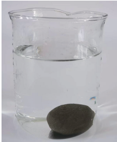
图3 脲醛树脂胶粉改性水泥球在水中不分散
