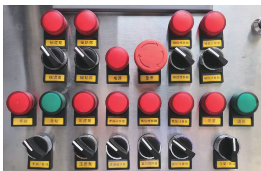
图2 FJS-1A型废浆处理设备手动控制面板
