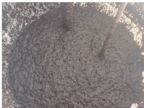
图6 废弃冲洗液破胶絮凝
