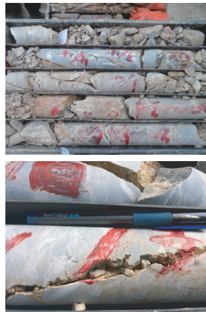
图3 某钻探现场典型孔壁坍塌漏失地层
