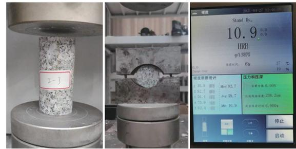
(a) 单轴压缩试验 (b) 巴西劈裂试验 (c) 点载荷强度试验
