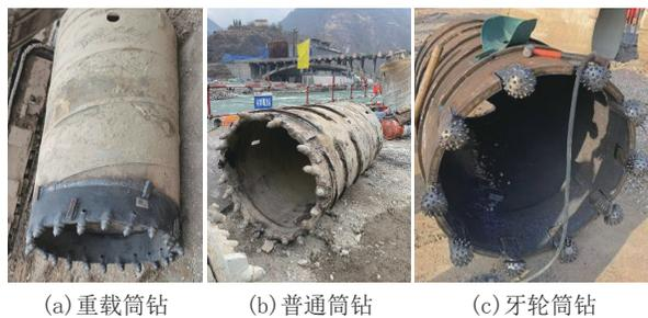
图15 三种筒钻实物
