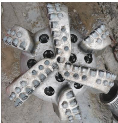
图5 优化后磨损较轻的PDC钻头
