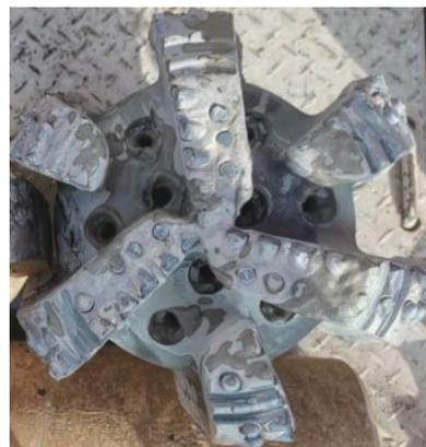
图3 6翼双排13片PDC钻头“环切”磨损
