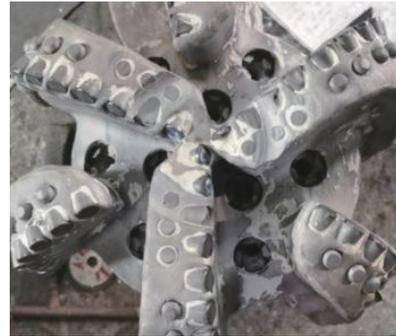
图6 “掏心”磨损的PDC钻头
