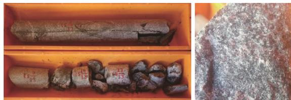
图8 硬度高、研磨性强、节理发育的岩心照片
