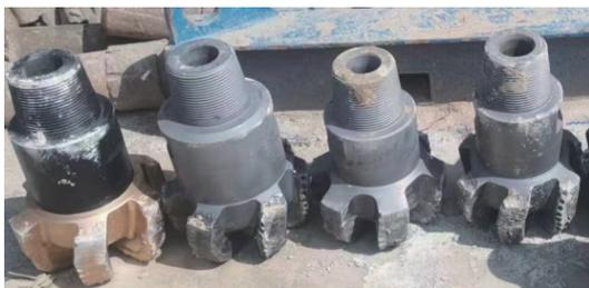
图7 PDC钻头实物照片
