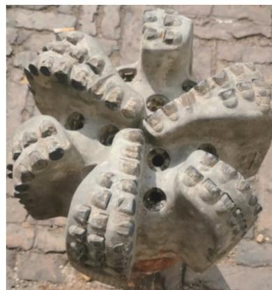
图4 6翼三排16片PDC钻头磨损情况
