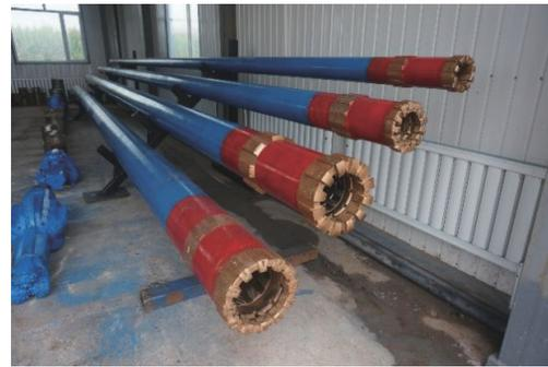
(b) 大口径同径取心钻具及钻头
