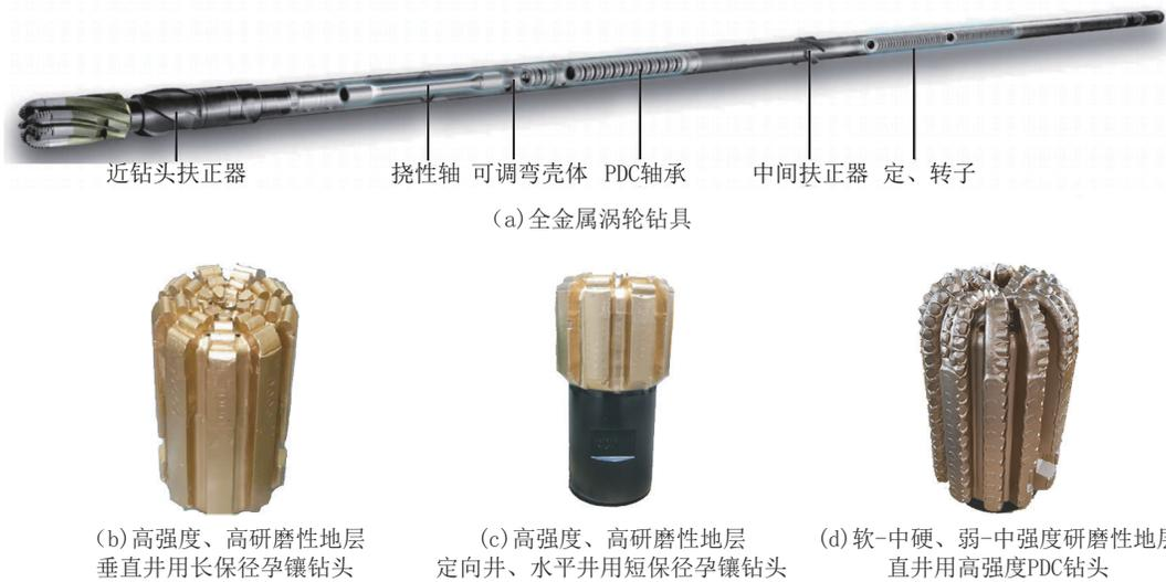
图2 全金属涡轮钻具+孕镶金刚石钻头或高强PDC钻头
