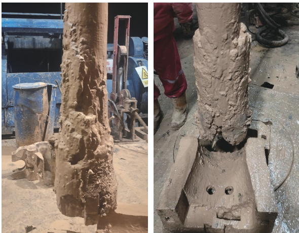
(a)PDC钻头 (b)三牙轮钻头 图3 泥包钻头情况
