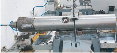
图13 旁通阀室内压力测试
