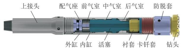
图1 CDH-125型气动潜孔锤结构示意图
