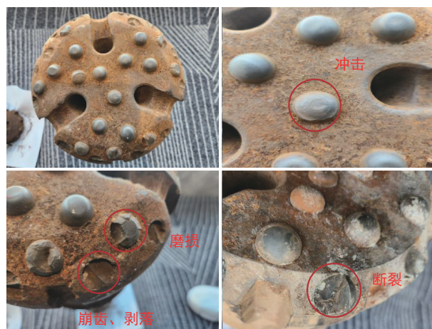
图2 潜孔锤钻头切削齿的总体失效情况
