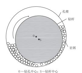
图 10 水平孔钻进示意
