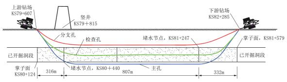
图 3 钻孔布置剖面示意
