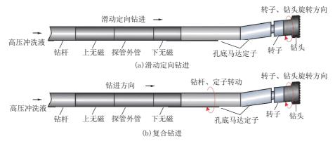
图7 滑动定向钻进和复合钻进原理示意[4]
