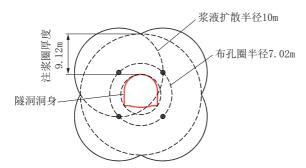
图 4 隧洞断面布孔示意
